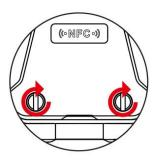
Verificare che l'anello di tenuta interno sia in buone condizioni, quindi installare il coperchio della batteria e serrare le due viti in senso orario.
